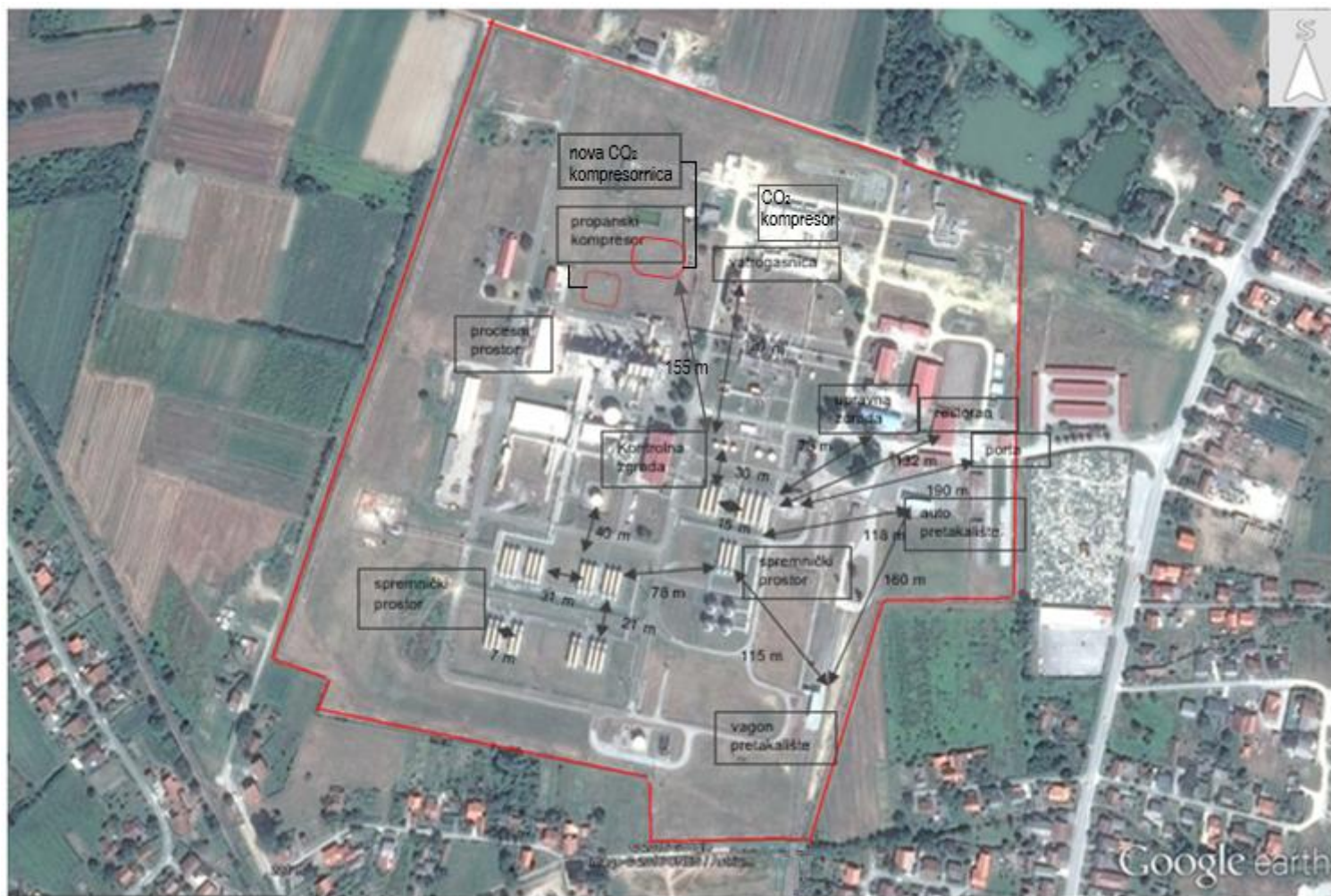
Grafički prikaz II-4: Prikaz međusobne udaljenosti objekata na području postrojenja OFIG
