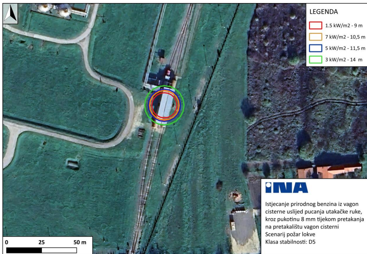
Grafički prikaz IV-37: Zone ugroženosti uslijed pretakanja prirodnog benzina uslijed puknuća utakačke ruke, kroz pukotinu 8 mm, na pretakalištu vagon cisterne
